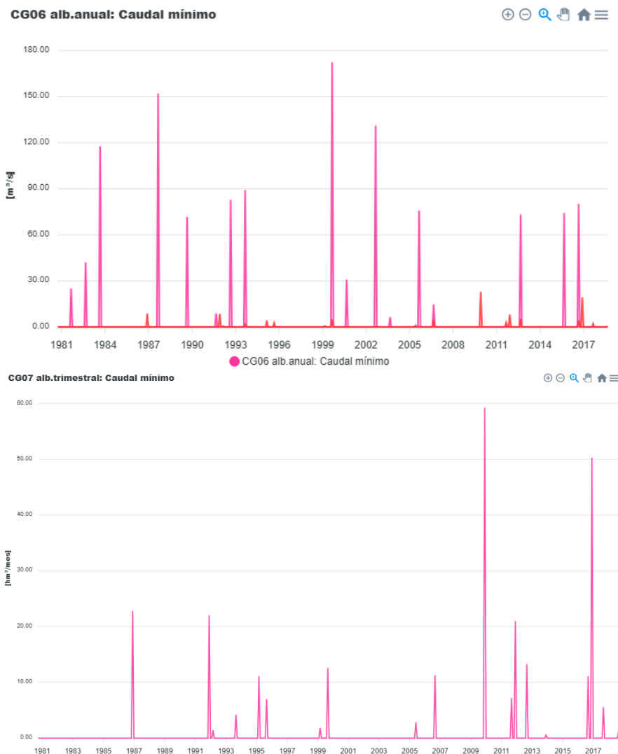
Figura 6: Series de caudales mínimos establecidos por la simulación para el cumplimiento de condiciones de Albufeira en escala anual y trimestral.
